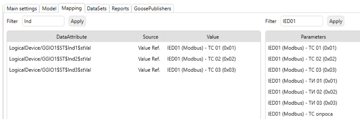
Рисунок 5.106. Пример работы фильтров при настройке 61850
